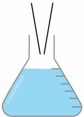
1. Knopf der Pipette bis zum ersten Druckpunkt drücken und die Spitze wenige Millimeter eintauchen lassen
